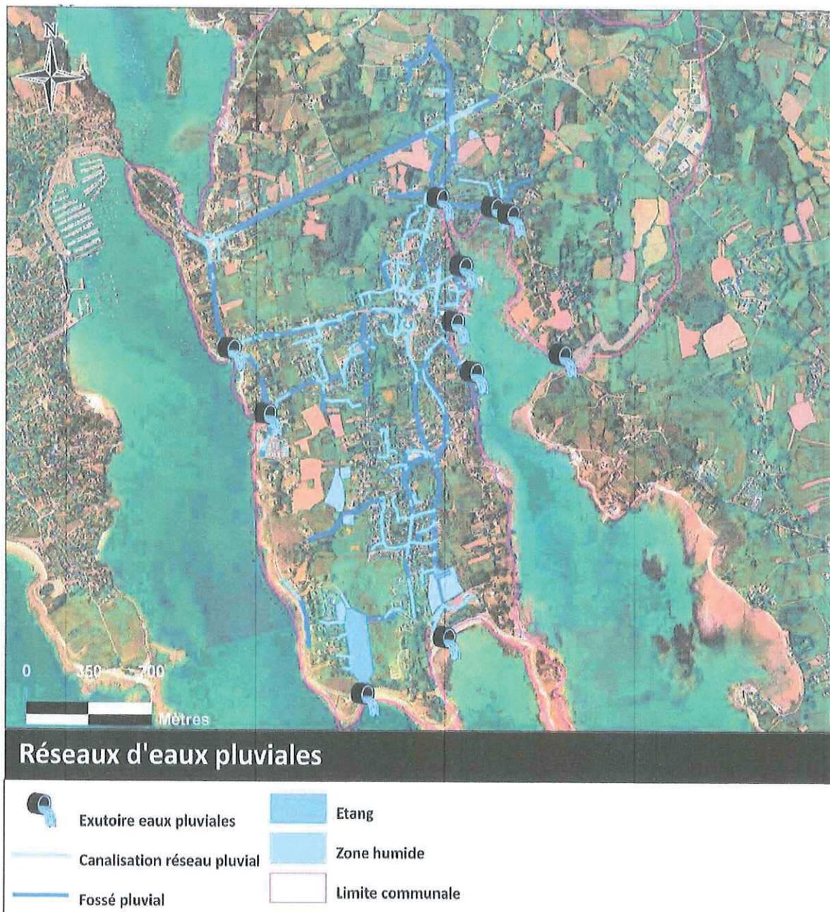
Figure n°38 : Réseau d'eaux pluviales de Saint-Philibert
