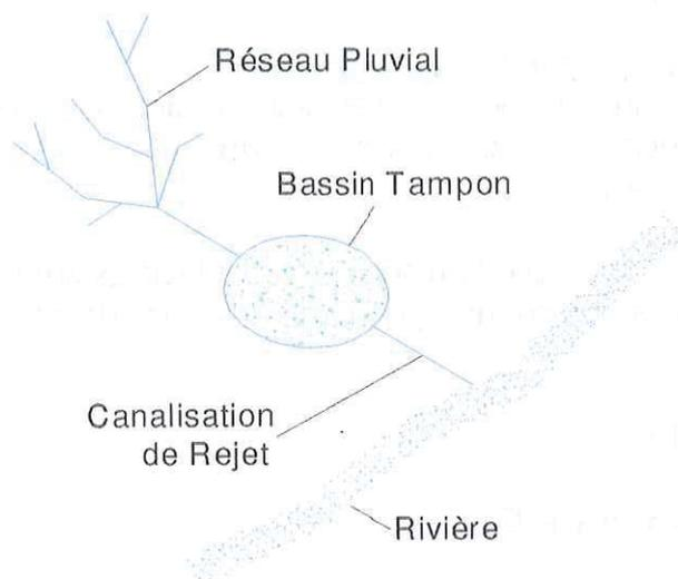
Dans le cas où le milieu récepteur est un réseau pluvial, ce système permet d'éviter les renforcements de réseau en aval.
