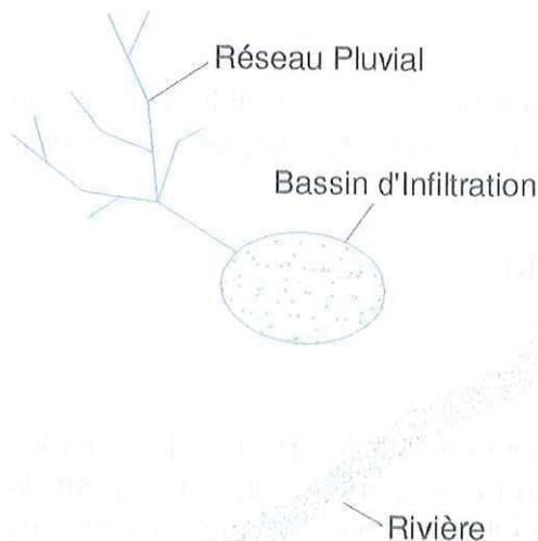
Il n'existe donc aucun rejet direct vers le milieu récepteur et ce type d'ouvrage permet de favoriser le rechargement de la nappe.
