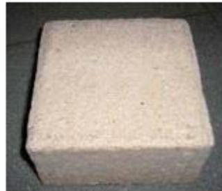
Pavés en béton poreux
