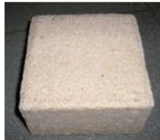
Pavés en béton poreux
